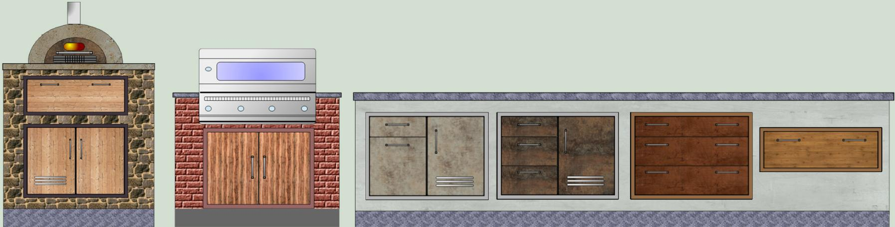
*Einbaukorpen mit Türen, Klappen und/oder Auszügen zum Einbau in bauseitige Öffnungen*
